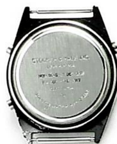
NSNのみでスペック番号はないが、1980年のMIL-W-87967にしたがって製作されたデジタルウォッチである。
