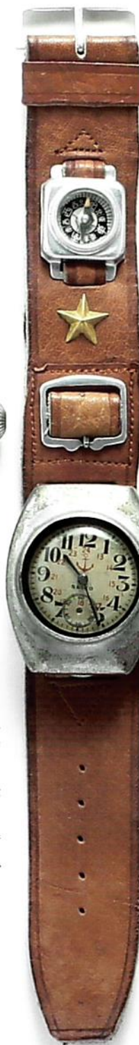
幅広の牛革ベルトは海軍航空時計に装着したもの。この時計は長いベルトで大腿部に巻きつけても使用した。大腿部への装着は操縦を妨げないという利点があり、イギリス軍やドイツ軍も大型時計はこうした使用方法をとっていた。
